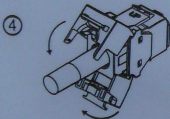
Den klappbaren Teil des Gehäuses mit einer geeigneten Zange (z.B. Rohrzanze) zusammenpressen bis er deutlich und vollständig einrastet.
