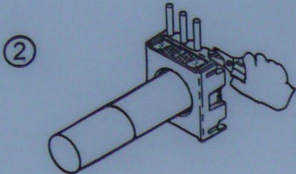
Kabel in den Kabelvorsortierer einführen und alle vier Aderpaare herausführen. Die einzelnen Leiterfarben entsprechend der TIA/EIA 568 A oder B Farbcodierung in die Schlitze einlegen. Stellen Sie sicher das sich der richtige Leiter im richtigen Schlitz befindet. Überstehende Aderenden kürzen.
