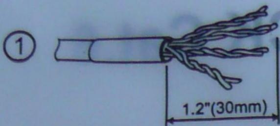
Kabel ca. 30 mm abisolieren, Geflechschirm nach hinten legen. Aluminiumfolie der Paarschirmung entfernen.
