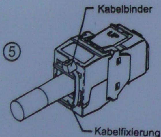
Kabelfixierung mittels Kabelbinder sichern
