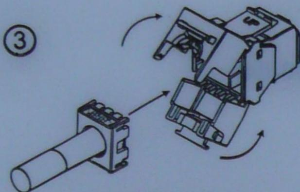
Kabelvorsortierer in das Gehäuse einsetzen. Die Adern werden dabei in die entsprechenden Schlitze geführt.
