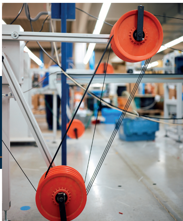
ABWICKELSTATION (TEIL EINER AUTOMATISCHEN KABEL- FERTIGUNGSMASCHINE)
