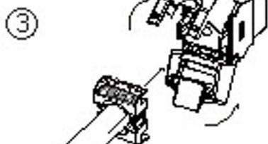
Abschlusskappe in das Gehäuse einsetzen. Die Adern werden dabei in die entsprechenden Schlitz geführt.
