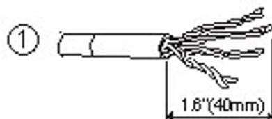
Kabel ca. 40 mm abisolieren, Geflechtschirm nach hinten legen. Aluminiumfolie der Paarschirmung entfernen. Mitgelieferte Kupferfolie außen über dem Geflechtschirm mit der Klebeseite nach innen anbringen.
