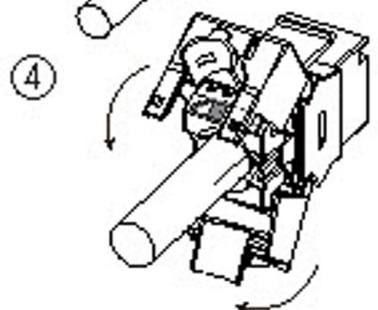
Den klappbaren Teil des Gehäuses mit einer geeigneten Zange (z.B. Rohrzanze) zusammenpressen bis er deutlich und vollständig einrastet.
