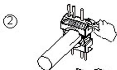
Kabel in die Abschlusskappe einführen und alle vier Aderpaare herausführen. Die einzelnen Leiterfarben entsprechend der auf der Abschlusskappe dargestellten Farbcodierung in die Schlitz einlegen. Stellen Sie sicher das sich der richtige Leiter im richtigen Schlitz befindet. Überstehende Aderenden kürzen.
